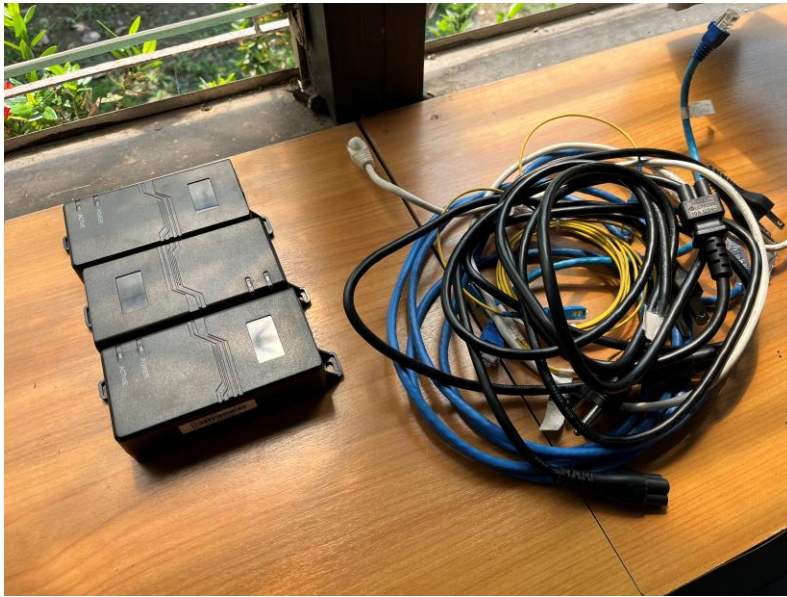
ภาพ Adapter จ่ายไฟให้ Access Point ที่ชำรุด
